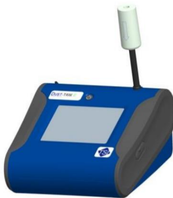
圖 3. DustTrak 零點校正示意圖
